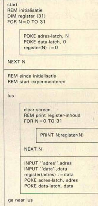
Figuur 5. Voor het comfortabel experimenteren met de interface is een eenvoudig programma voldoende. De structuur van zo'n programma is in deze figuur weergegeven.
